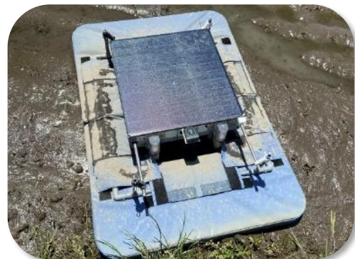
田の雑草を抑制するアイガモロボット
