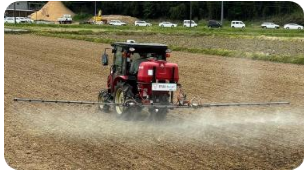
自動操舵システムを付属させたブームスプレーヤー
