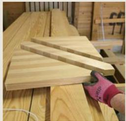
プレスした板を木目が斜めに走るように切り、上の面と下の面をプレス機でさらに圧着します。
