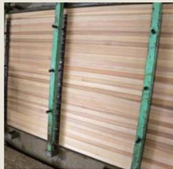
スギ材の白い箇所と赤い箇所を交互に積み重ね、プレスして圧着し、大きな1枚の板を作ります。
