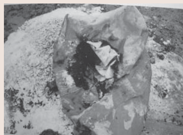
放置していた生石灰に雨水が掛かり発熱し、着火したものの
