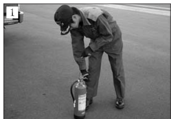
1 ■火元に近づき消火器の上にある安全栓を上引き抜く ※運ぶ途中にレバーを握って火と空気が漏れ出す恐れがあります。
