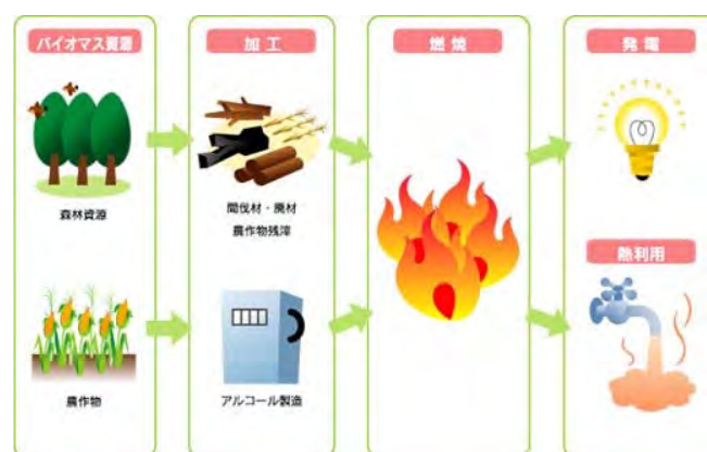
図 1-7 バイオマス発電・バイオマス熱利用の概要
