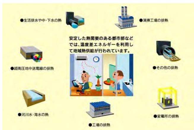
図 1-8 温度差熱利用の概要
