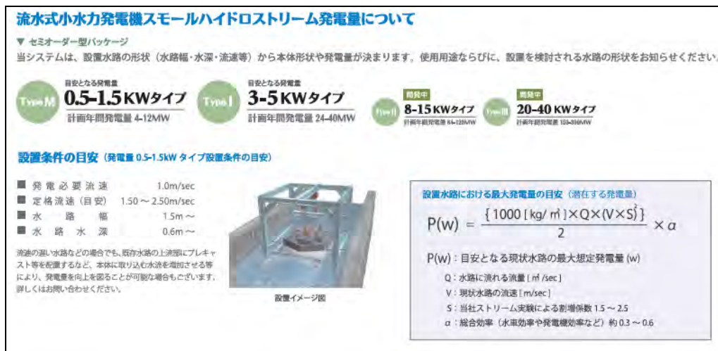
図 2-36 マイクロ水力発電の仕様
