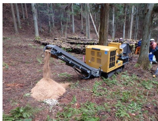
ほだ木破碎の様子 2
