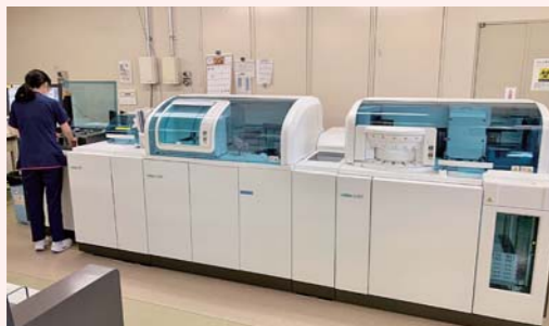
多項目分析装置により一度に57項目の検査が可能
