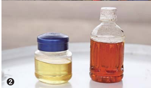
①廃食油が入っていたタンクを洗う施設利用者の皆さん。一人一人が回収から精製まで一連の作業を行います②精製したBDF(左)と廃食油
