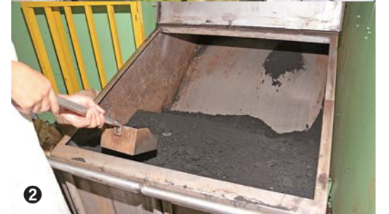
①肥料にできないごみを分別して、機械で細かく刻む。刻んだ後は、装置に投入②完成する肥料の量は、投入した廃棄物の10分の1
