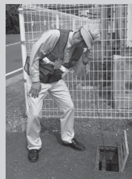
▲音聴棒という器具で振動音を聞き、漏水の有無を確認します
