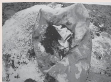
放置していた生石灰に雨水が掛かり発熱し、着火したものの
