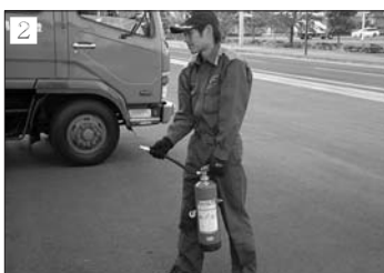
2 ■ホースをはずし、ホースの先端を握り火元に向ける ※ホースの途中を持つと、放射の圧力などから狙いが定まらず、的確に放射できない恐れがあります。
